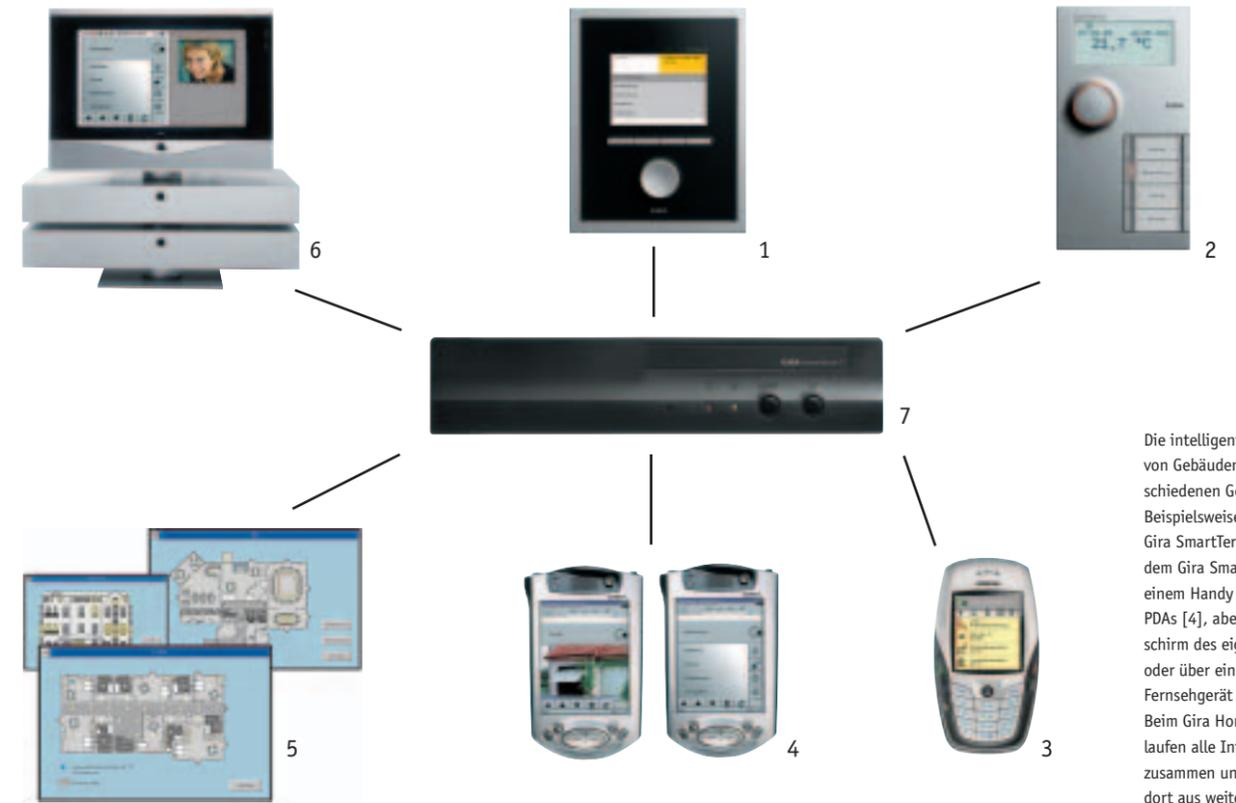
Die intelligente Steuerung von Gebäuden ist mit verschiedenen Geräten möglich. Beispielsweise mit dem Gira SmartTerminal [1], dem Gira SmartSensor [2], einem Handy [3] oder mit PDAs [4], aber auch am Bildschirm des eigenen PCs [5] oder über ein internetfähiges Fernsehgerät [6]. Beim Gira HomeServer 2 [7] laufen alle Informationen zusammen und werden von dort aus weiter verteilt.
