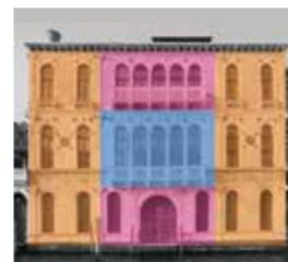
Schema 4: Das liegende Rechteck in der Mittelachse der Schauffassade ist im Maßverhältnis 8:5 angelegt.
