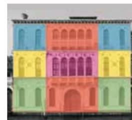
Schema 3: Das Maßverhältnis der geschossweisen Mittelteile zu den geschossweisen Seitenteilen beträgt 8:5.
