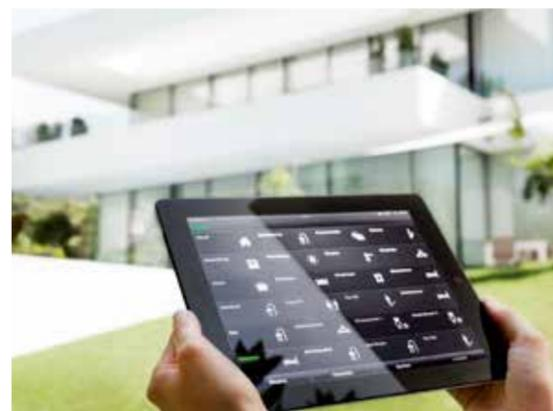
Ganz oben: Der Gira Control 19 Client dient mit seinem Touchscreen als Kontroll- und Steuereinheit für die gesamte Gebäudetechnik. Hier lassen sich zudem Verlaufsdiagramme anzeigen – beispielsweise zum Energieverbrauch.
